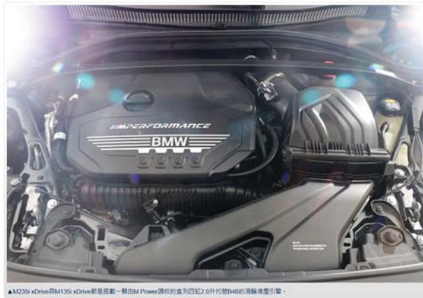
▲M235i xDrive與M135i xDrive都是搭載一顆由M Power調校的直列四缸2.0升代號B48的渦輪增壓引擎。
